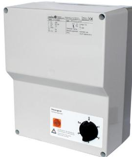
**RTD..(G)** Die Steuergeräte dieser Bauart besitzen einen Anschluss für einen Strömungswächter und ein Gasmagnetventil. Der Strömungswächter muss im Luftstrom des Ventilators angebracht werden. Wird durch den Ventilator eine ausreichende Luftmenge gefördert, so wird das Gasmagnetventil über den Strömungswächter zugeschaltet. Der Einsatzbereich dieser Geräte ist bevorzugt in der Küchenabluft, wenn Gasgeräte installiert sind.
